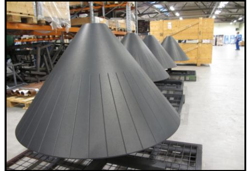
Koner belagt med Accowear, som slidforstærkende lag til brug i fødevarerindustrien.
