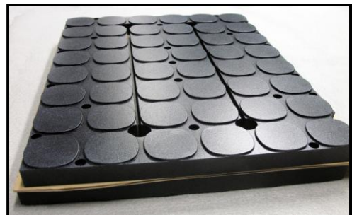
Svejseplade til fødevarerindustrien belagt med Accowear som slidforstærkende lag.
