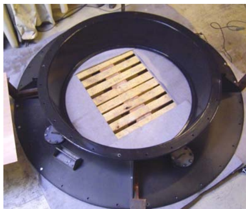
Stor ring ø 2.2 m belagt med Accoshield
